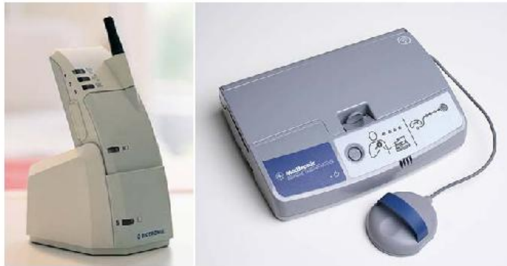
Abb. 3 ▲ Patientenmonitore mit automatischer und manueller Datenübertragung zwischen Implantat und Patientenmonitor (linkes Bild: CardioMessenger 2 von BIOTRONIK mit automatischer Datenübertragung zwischen Implantat und Patientenmonitor; rechtes Bild: CareLink-Monitor von Medtronic mit manueller Abfrage des Implantates)
